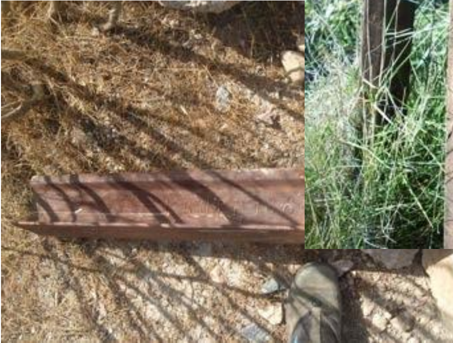
Raíl originario fabricado por la empresa alemana Krupp en 1884
